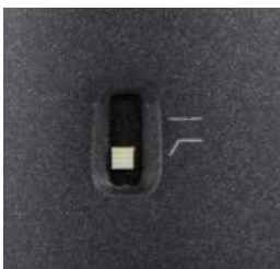
Illustration 2: Sélecteur de réduction des basses
