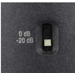
Illustration 1: Sélecteur de pré-atténuation
