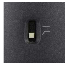
Figura 2: Conmutador-selector para atenuación de bajos
