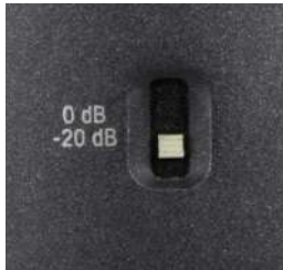
Abbildung 1: Wahlschalter für Vorabschwächung
