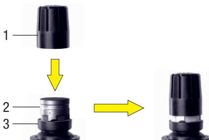
Figura 6: Come montare il PPC1000/PB1000
