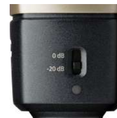
Figura 2: Conmutador-selector para la atenuación de bajos
