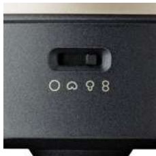
Abbildung 1: Wahlschalter für Richtcharakteristiken
