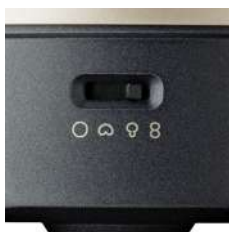
Figura 1: Conmutador-selector para las características direccionales
