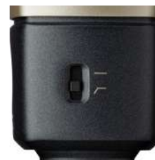
Figura 3: Conmutador-selector para la atenuación de bajos
