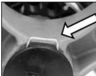
Fig. 38 Pino de bloqueio da roda traseira
