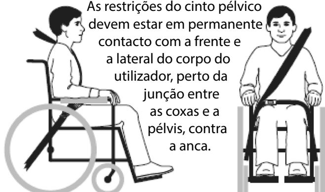
Figura 3b - Rotação e posicionamento adequados dos cintos de segurança, no utilizador da cadeira de rodas.
