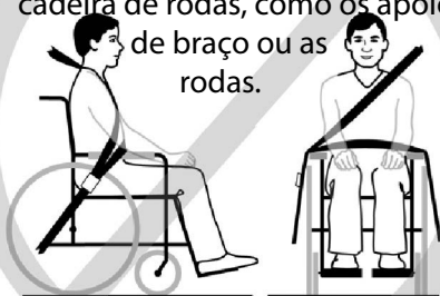
Figura 3a - Posicionamento incorreto do cinto pélvico sobre os suportes da cadeira de rodas.
