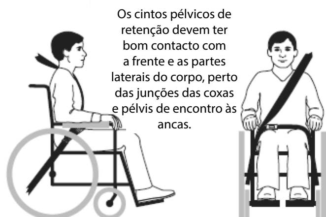
Figura 3b - Posicionamento correto de cintos de retenção do ocupante de cadeira de rodas.
