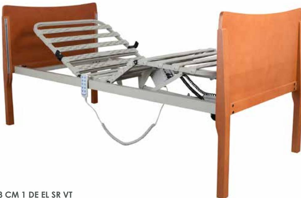
Línea recomendada para ambientes con riesgo bacteriológico medio/alto. Estructura en acero de 60x30x1,5mm con pintura epoxi. Bastidor cuatro planos con 3 cuerpos articulados y 1 fijo, con lamas en fibra de polímero. Articulación eléctrica del respaldo y piernas, por 2 motores de 6000N de baja tensión y mando de uso intuitivo. Con 2 soportes para accesorios de serie en la estructura. Piernas en madera maciza con panel del cabecero y piecero en melamina.
