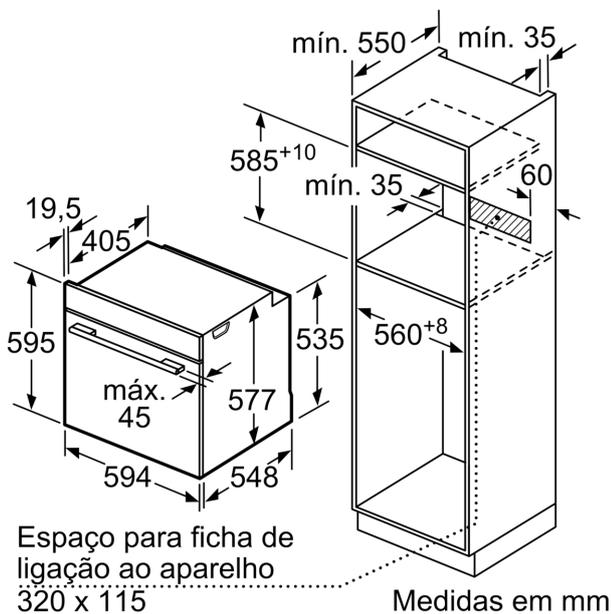
Se o aparelho for instalado por baixo de uma placa de cozinhar, tem de ser observada a seguinte espessura da bancada (se necessário incl. estrutura inferior).
