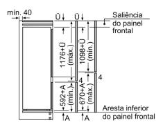
As medidas indicadas das portas dos móveis são válidas para uma junta de porta de 4 mm. Medidas em mm
