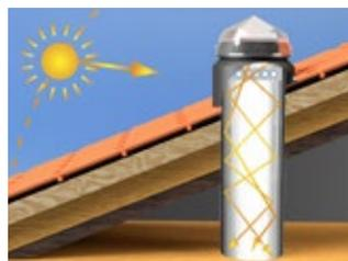
Intégration de l'éclairage Led dans les tubes solaires, ce qui permet un éclairage efficace 24h / 24. Au cours de la journée et par temps ensoleillé, l'éclairage de l'espace provient du soleil. À l'approche de la nuit ou de l'obscurité du jour, la console «Light Controller» de Chatron alimente les voyants pour maintenir constants le niveau de lux souhaité et sélectionné à cet endroit.
