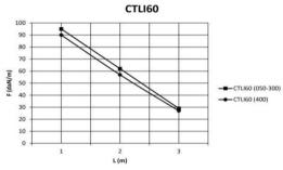
Werte aus Belastungsprüfungen nach der Norm IEC 61537, Prüftyp III. Verbindung auf 1/5xL von erster und letzter Stütze, Endspannweite = 0.8xL, 5xBN06-10-EG
