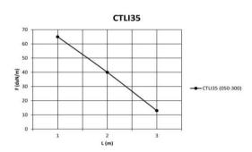
Werte aus Belastungsprüfungen nach der Norm IEC 61537, Prüftyp III. Verbindung auf 1/5xL von erster und letzter Stütze, Endspannweite = 0.8xL, 3xBN06-10-EG
