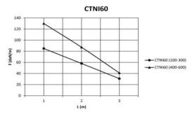
Werte aus Belastungsprüfungen nach der Norm IEC 61537, Prüftyp III. Verbindung auf 1/5xL von erster und letzter Stütze, Endspannweite = 0 nweite = 0.8xL, 4xBN06-10-EG
