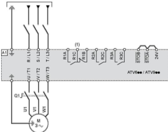
(1) Utilize a saída digital R1 definida para o estado de operação Falha para desligar o produto quando for detectado um erro.
