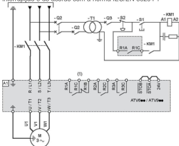
(1) Utilize a saída digital R1 definida para o estado de operação Falha para desligar o produto quando for detectado um erro.
