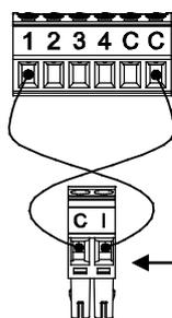
Hasta dos sensores de movimiento conectados en paralelo en la misma entrada del dispositivo
