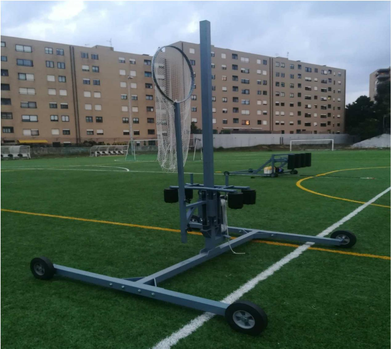
La máquina lineout proporciona práctica de técnicas y movimientos de elevadores y lanzadores.
