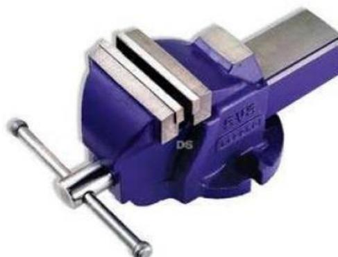
Tornos de bancada rígidos e robustos com mordentes de aço endurecido. Porca em aço SG à prova de roturas, substituível em caso de desgaste. O eixo, de aço fundido, dobra se o torno tiver excesso de pressão.
