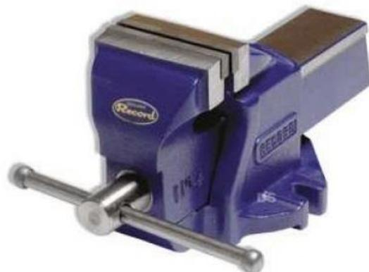
Tornos de bancada rígidos e robustos com mordentes de aço endurecido. Porca em aço SG à prova de roturas, substituível em caso de desgaste. O eixo, de aço fundido, dobra se o torno tiver excesso de pressão.
