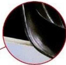
La garde sert de guide en appui sur la tôle.
